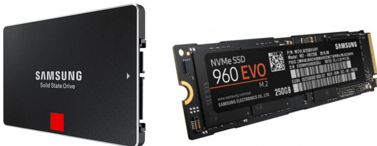
Slika 5: SSD diska Samsung 860 Pro in M.2 kartica Samsung 960 EVO.
